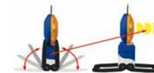
Automatisches Ein- und Ausschalten durch Auf- oder Zuklappen der Standbügel
